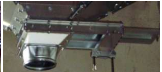
Veitsisuljin ketjupyörällä saatavuus: 200mm ja 250mm myös moottoroituna
