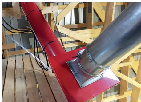
Tippesjakt / 160/200mm rørkobling til tippesjakt
