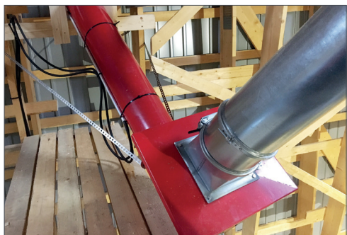
З'єднання силоса з металевим приймальним лотком транспортера (160мм / 200мм)
