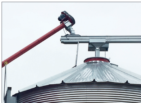
З'єднання шнекового транспортера з силосом (200мм / 250мм)
