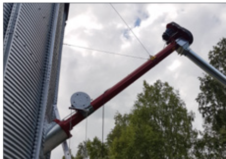
Підтримка за допомогою дроту / Дистанційне керування подачею зерна
