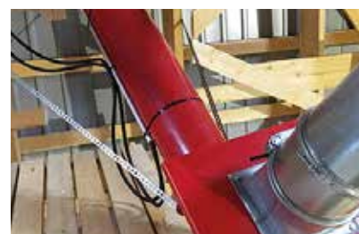
Tippficka / 160/200 mm rörkoppling till tippfickan
