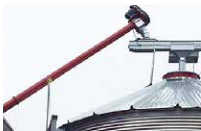
200/250 mm rörkoppling till tömningsändan
